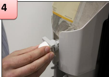
*Guider ensuite l'embout de la recharge à travers la fente du support.*
